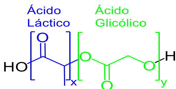
Figura 7. Estructura de ácido poli-láctico co- glicólico (x: número de unidades de ácido láctico, y: número de unidades de ácido glicólico). [139]
