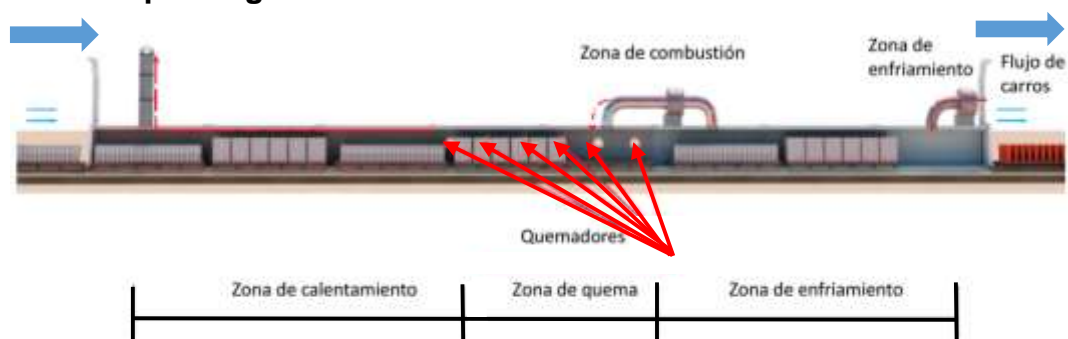
Figura 3. Esquema general de un horno túnel.
