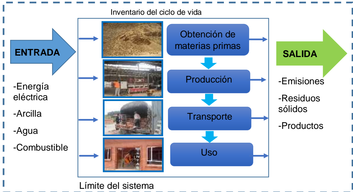
Figura 2. Representación del análisis de ciclo de vida de la fabricación de ladrillos.
