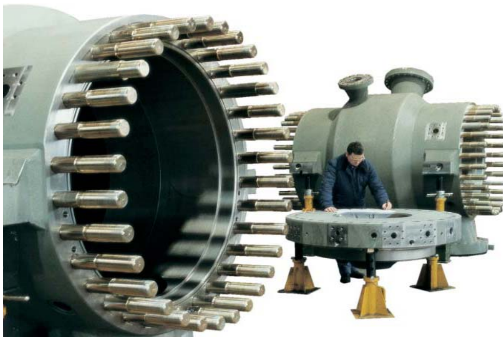
Figura 2. Cubierta del compresor.
