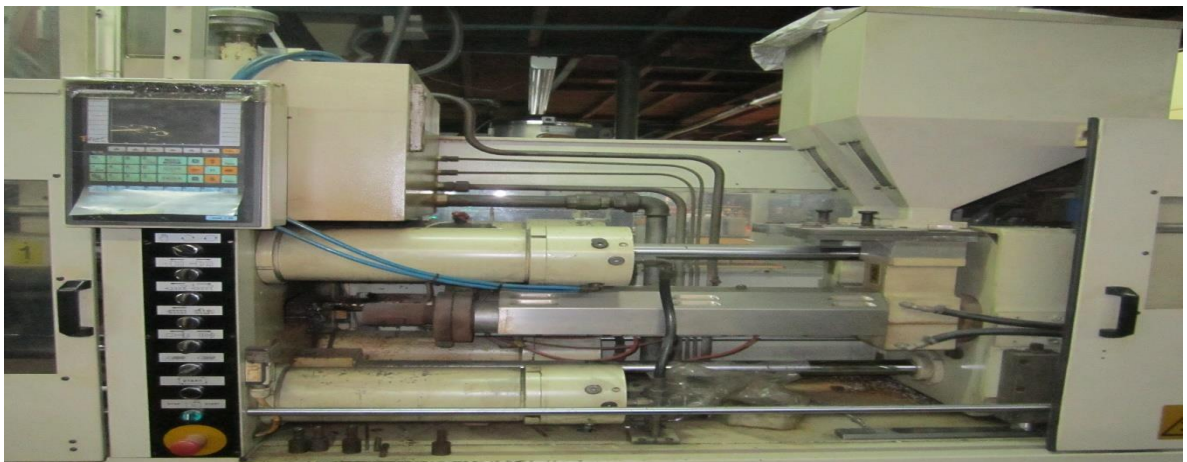
Figura 21. Unidad de inyección típica.
