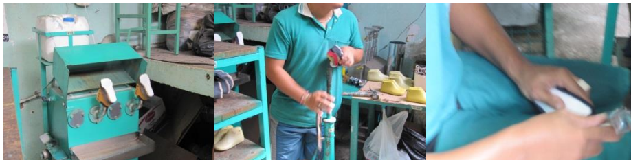
Figura 11: Proceso de preformado.
