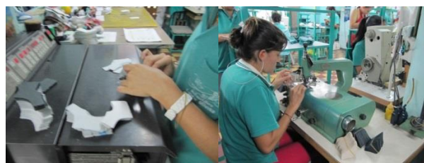
Figura 8: Proceso de desbaste.
