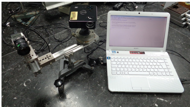
Figura 29. Sistema de reconstrucción 3D implementado.
