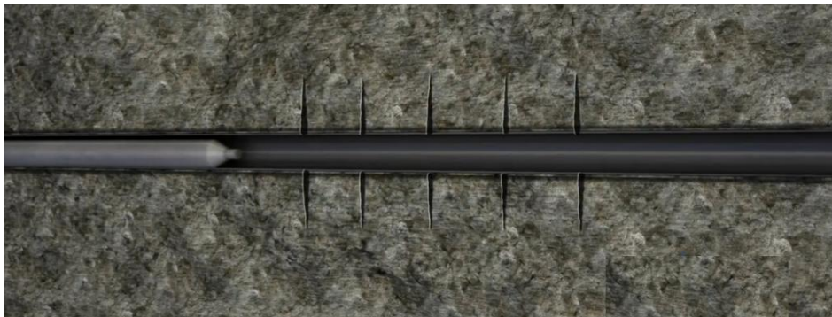
Figura 7. Completamiento a hueco abierto
