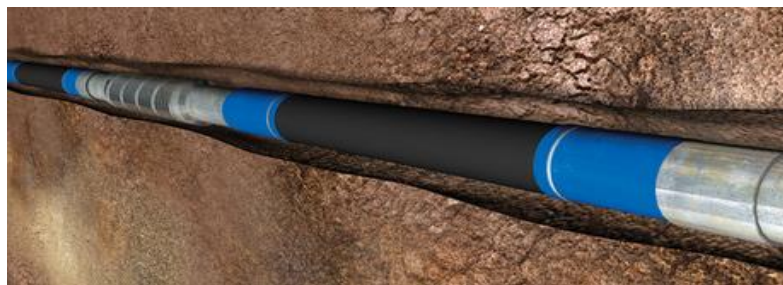
Figura 6. Completamiento con aislamiento parcial del liner
