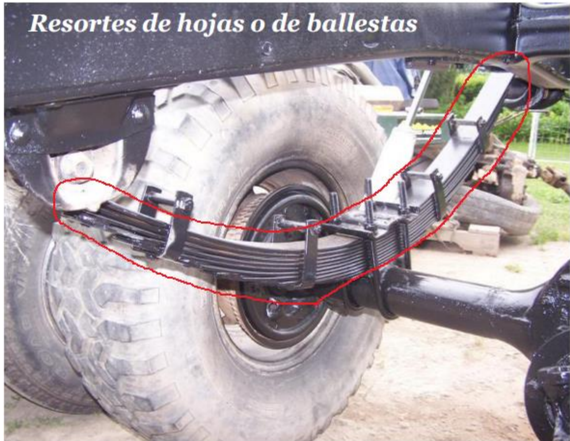
Figura 1. Aplicación de los resortes a Tensión.
