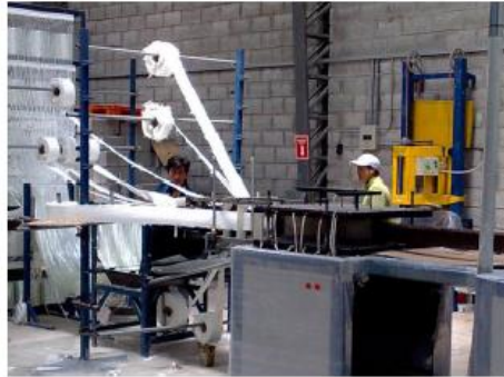
Figura 4. Proceso para realizar la pultrusión
