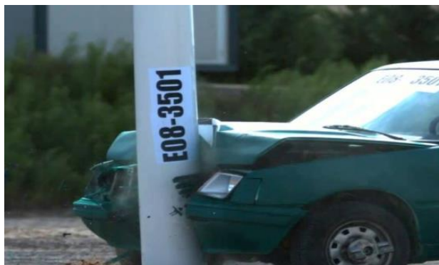
Figura 10. Estructura resistente a fuerzas de impacto.
