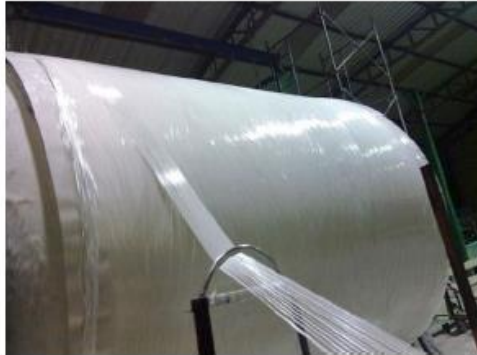
Figura 2. Proceso para realizar el laminado
