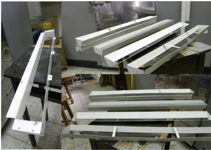
Figura 37. Boquillas de impulsión y caja soporte.
