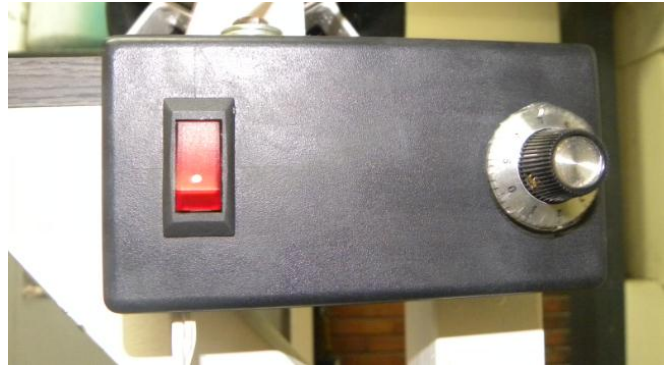
Figura 43. Caja de control de velocidad.
