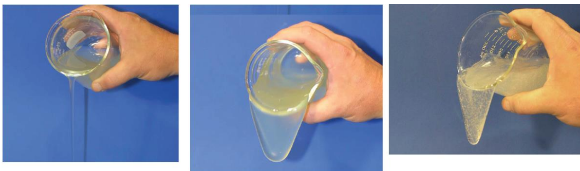
Figura 14. Apariencia de un gel base, un gel reticulado con borato y un gel reticulado con zirconio
