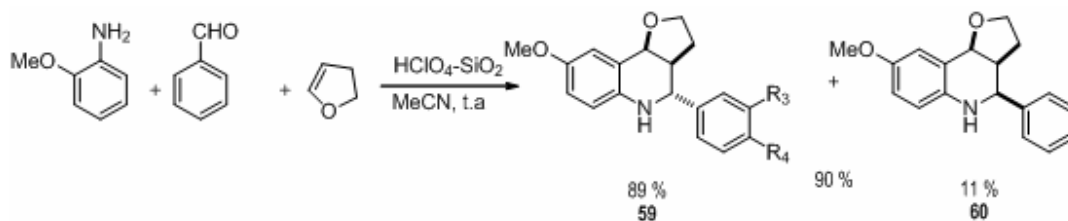
Esquema 15. Síntesis de THQ a partir de ácidos de Brønsted soportados sobre gel de sílice.
