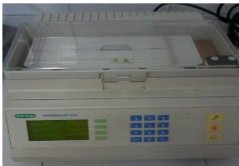
Figura 8. Equipo de Isoelectroenfoque. Las proteínas se separan de acuerdo a su punto isoeléctrico. En la separación se utilizan tiras rehidratadas con la muestra de proteínas, que se encuentran ubicadas en la bandeja.
