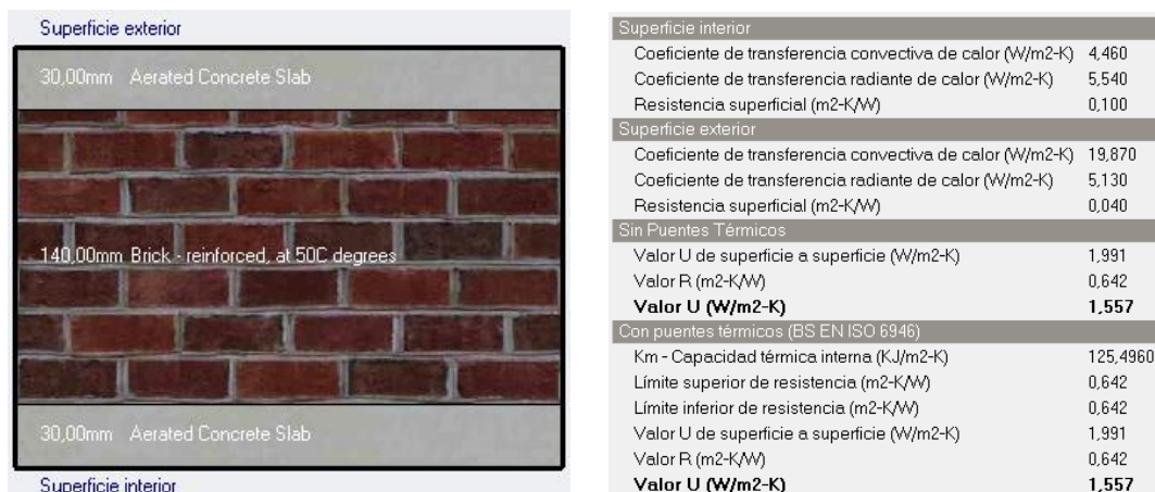
Figura C. 12. Propiedades de transmisión de calor de la Cubierta Plana del primer piso en DesignBuilder.
