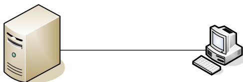
Figura 1. Servidor DHCP y un cliente comunicados por cable cruzado.
