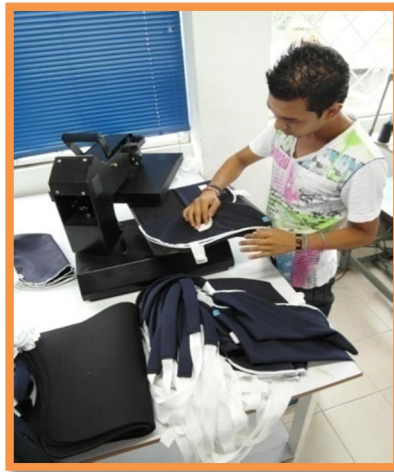
Figura 19: Proceso de estampado en plastitransfer.
