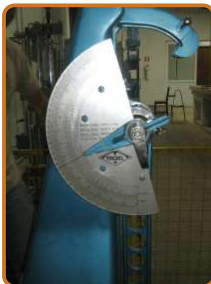
Ilustración 35. Medición de resistencia de prueba de impacto.
