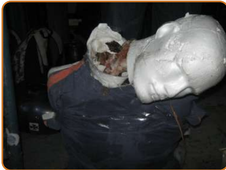
Ilustración 47. Fractura generada por impacto frontal en prueba de alternativa 5
