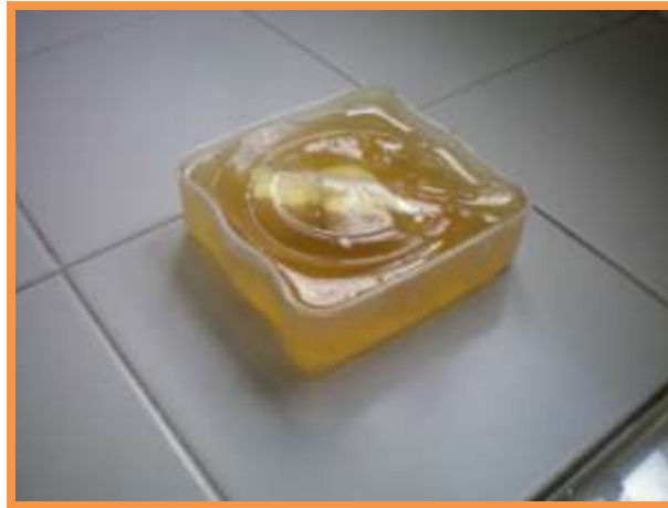
Ilustración 30. Probeta de gel de moldeo con interior de poliestireno expandido.
