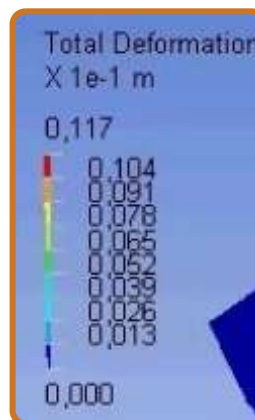
Figura 77. Medidas por colores de la escala de deformación de la alternativa 1 evaluada en Ansys Workbench 8.0.
