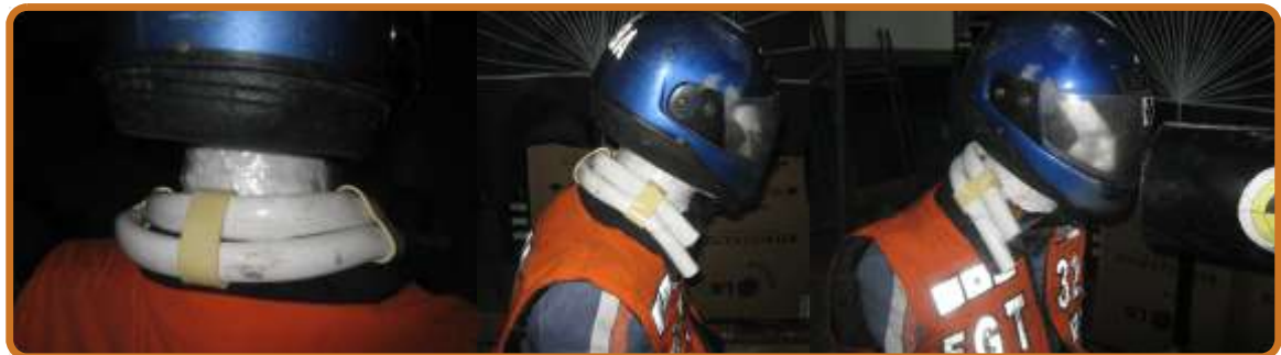
Ilustración 45. Preparación muñeco de pruebas para impacto frontal alternativa 5.
