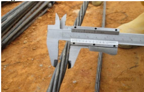
Figura 3. Verificación Diámetro Torones.
