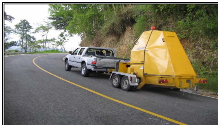
Figura 7. Deflectómetro de impacto KUAB 50
