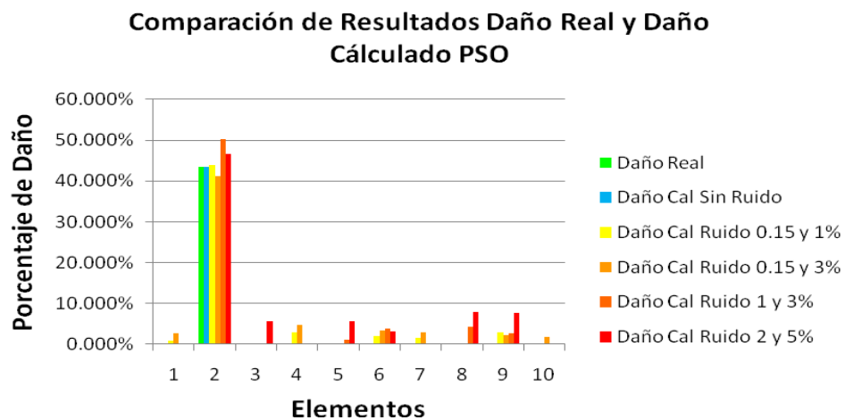
Figura 16. Comparación del Daño Real y el Daño Calculado en la viga con diferentes cantidades de ruido: Función objetivo CalibraV1, daño simple, 8 modos de vibración
