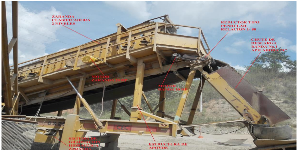
Figura 30. Zaranda y chutes de descarga con banda de salida zaranda y descarga a banda
