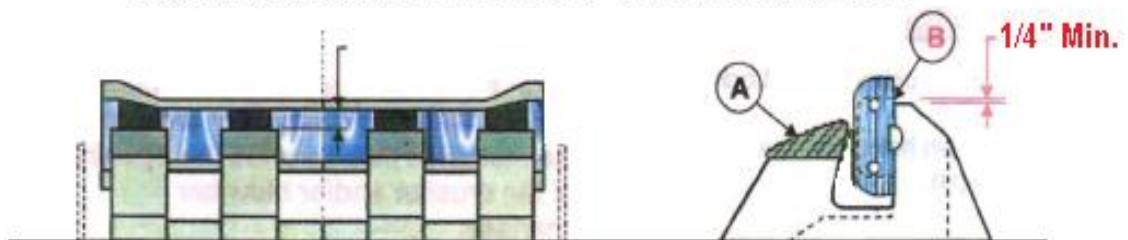
Fig. 9d: MARTILLO DESGASTADO "listo para sustitucion"
