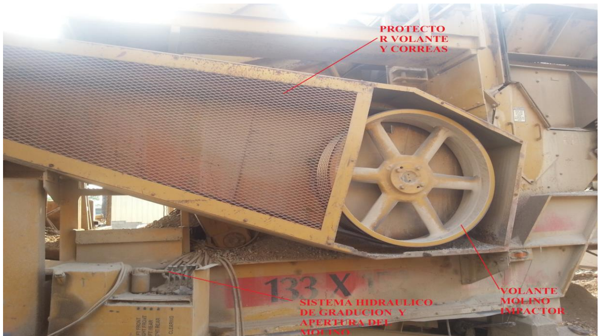
Figura 25. Parte motriz del molino, con su volante, protector correas e hidráulico
