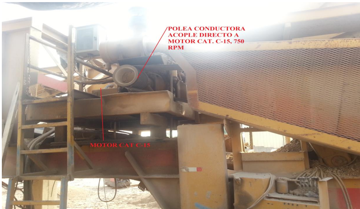
Figura 26. Sistema motriz polea motor CAT. C-15 260 HP A 1800 rpm
