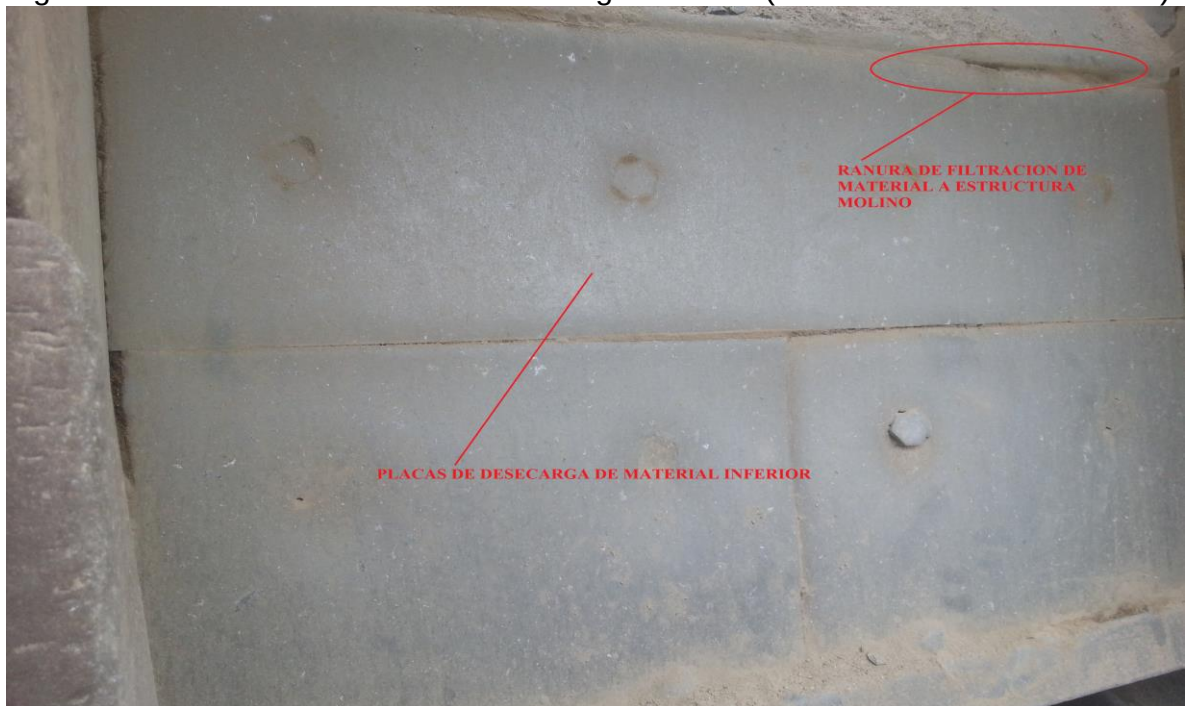
Figura 37. Parte inferior molino de descarga a banda (salida del material triturado)
