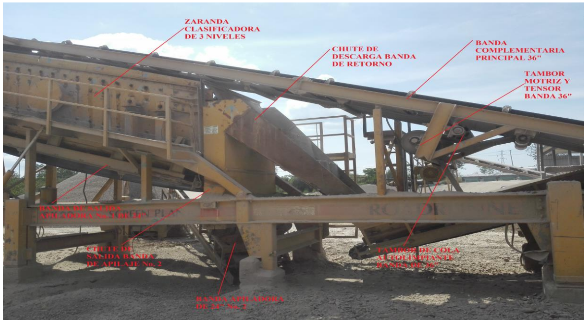
Figura 29. Chasis No. 2 banda completaría llegada a zaranda clasificación y chutes
