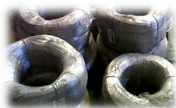
Figura 5. Alambre re trefilado BWG 21”
