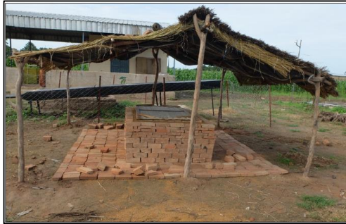
Figura 8. Cámara de enfriamiento evaporativo natural.
