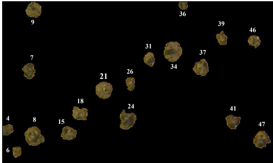
Figura 21. Regiones nodulares de grafito que tienen un factor de forma entre 0.8 y 1.5 y a la vez tienen un área mayor de 2.64839 \times 10^{-4} \text{ mm}^2 .
