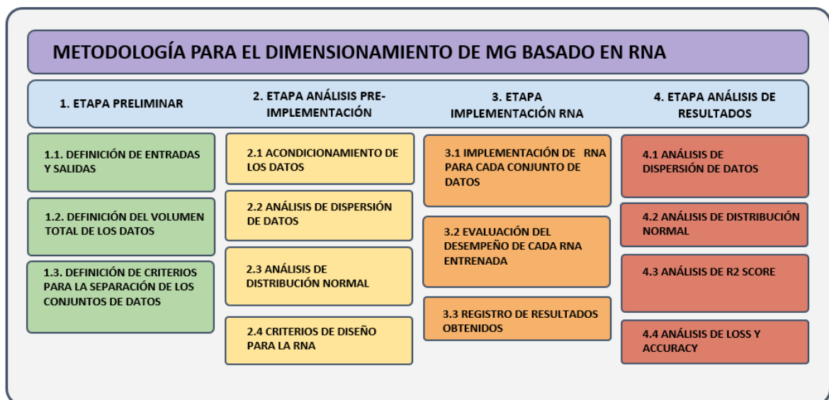
Figura 9. Metodología empleada para el dimensionamiento de MG a partir de modelos basados en RNA.
