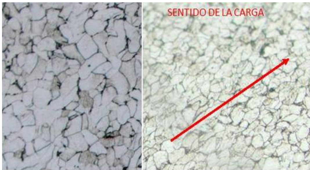
Figura 31. Comparación de estructura granular entre la probeta original y luego de una deformación con carga aplicada de 375 MPa.
