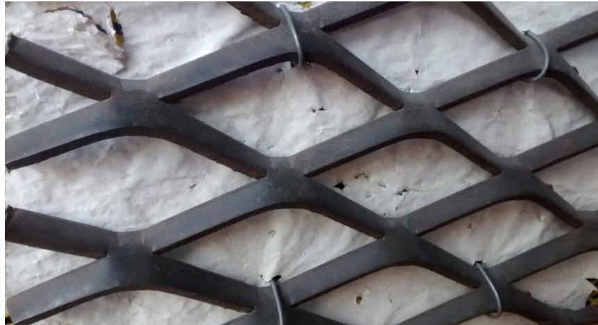
Figura 8. Lámina de metal expandido, suministrada por mallas especiales
