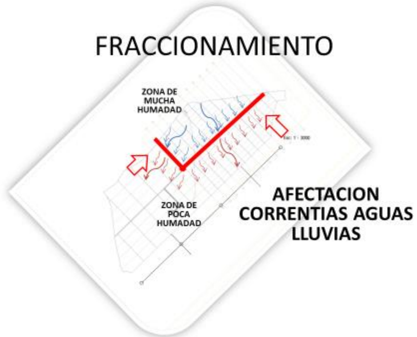
Figura 19: Afectación Correntías Aguas Lluvias.
