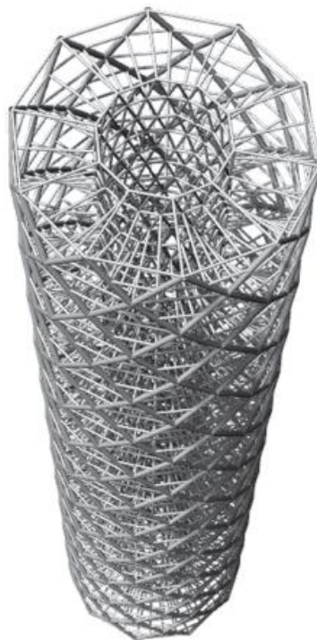
Figura 23. Ejemplo de modelo estructural de un sistema Diagrid. (Mirniazmandan, Alaghmandan, Barazande y Rahimianzarif, 2018)
