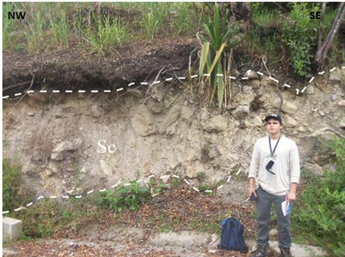
Figura 59. Suelo de tipo coluvial sobre la vía Málaga- Molagavita, a dos kilómetros del casco urbano del municipio de Molagavita
