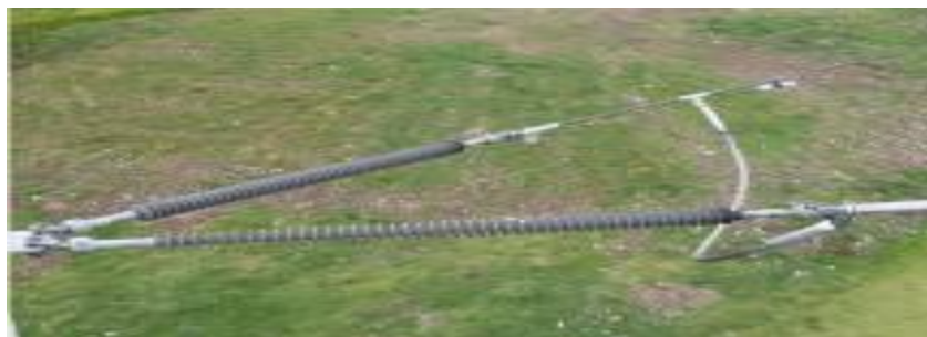
Figura 17. Aislador polimérico (retención para 115kV)
