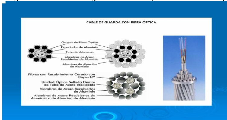
Figura 14. Cable de guarda OPGW (corte transversal)
