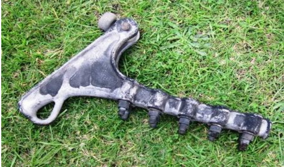
Figura 21. Grapa de retención para 115kV (afectada por contaminación)
