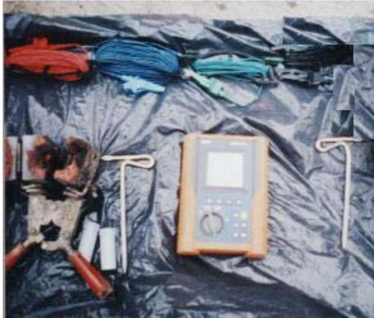
**Figura 24. Telurómetro, molde de grafito y soldadora exotérmica**
