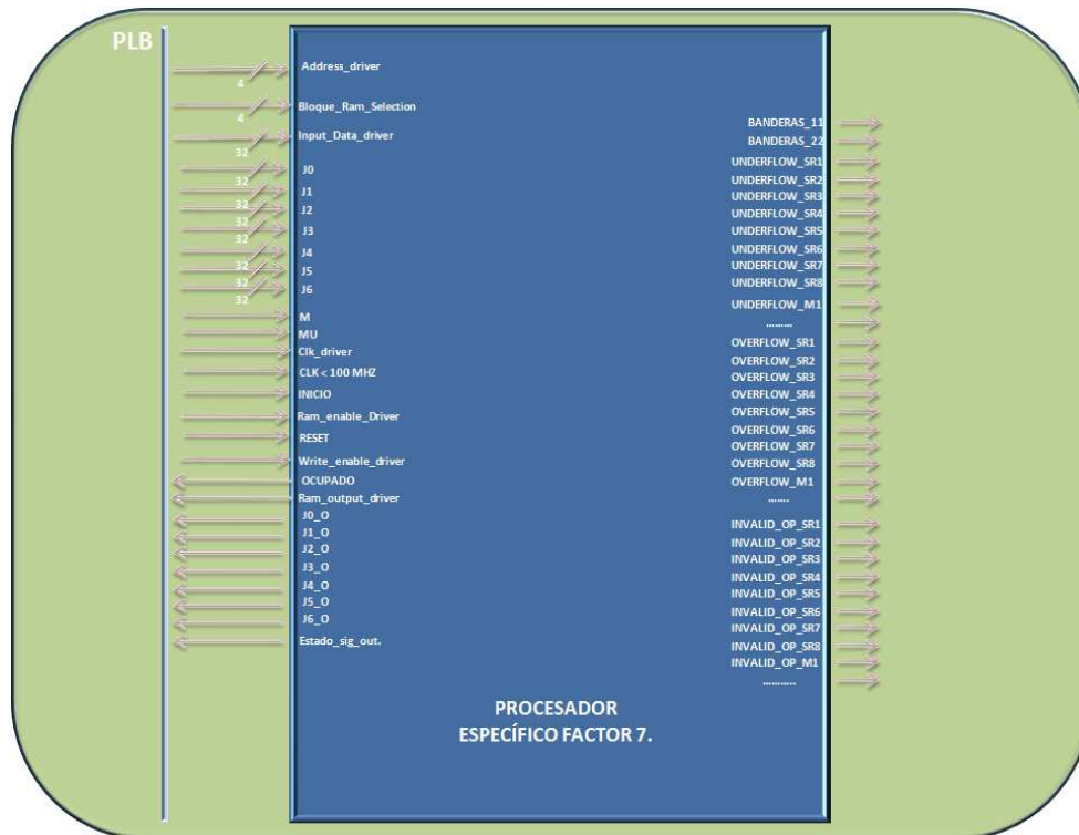
Figura 3.1: Entidad del procesador: Señales de entrada y salida del periférico.
