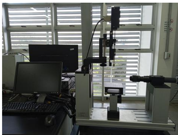
Figura 12. Tensiómetro OCA 15 EC usado durante las mediciones de tensión interfacial.
