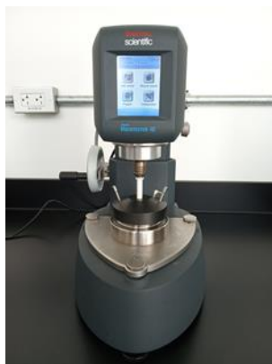
Figura 11. Reómetro HAAKE Viscotester IQ usado durante las mediciones.
