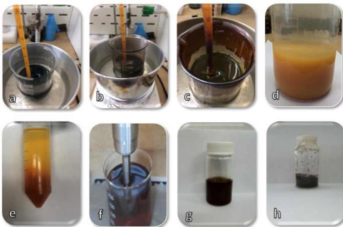
Figura 9. Imágenes obtenidas durante la síntesis del GO. a) Homogeneización del grafito con ácido sulfúrico. b) Mezcla inicial y c) final de reacción. d) Dispersión después de la hidrólisis y e) durante los lavados. f) Sonicación, g) dispersión final y h) producto liofilizado.
