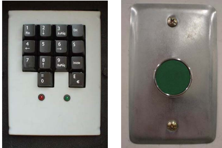
Figura 8. Medios para apertura de la puerta. Izquierda: Teclado de Acceso. Derecha: Pulsador.
