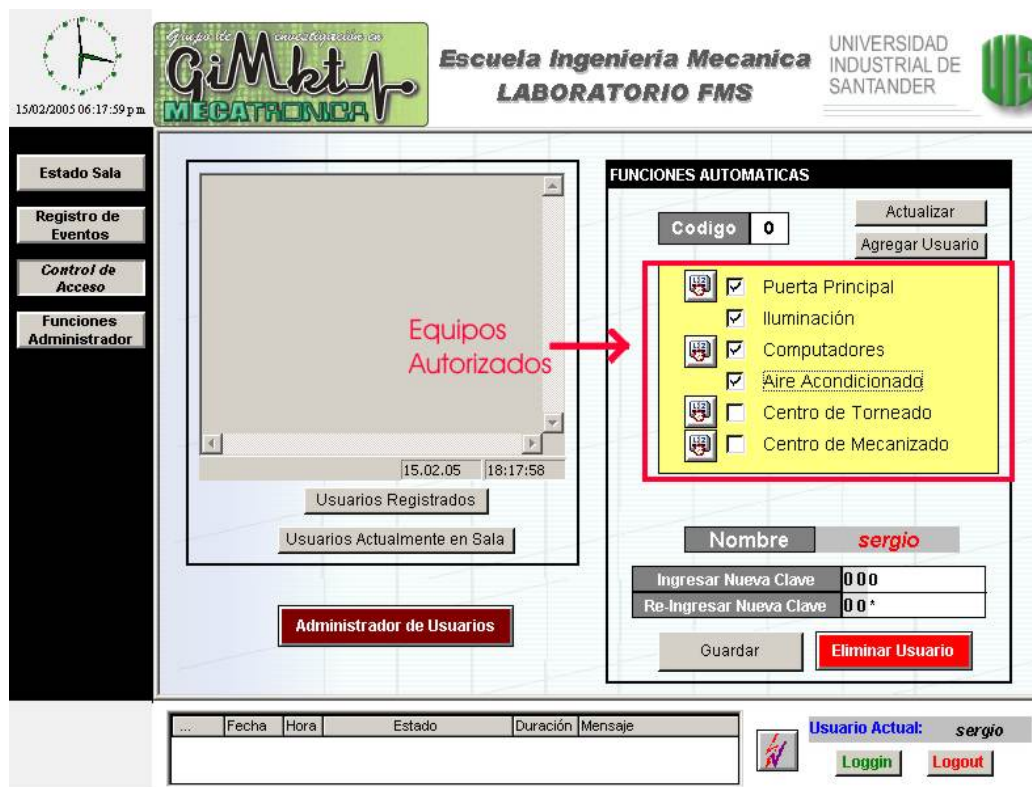
Figura 36. Ventana “Control Acceso”. Equipos Autorizados
