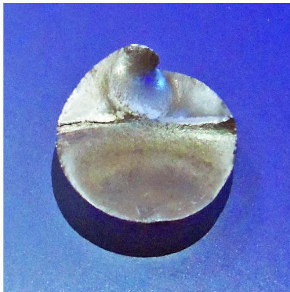
Figura 21. Ejemplo Real de una Falla por Fatiga.
