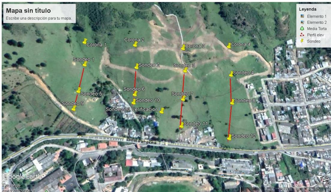
Figura 36. Planta ubicación de los sondeos exploratorios. Adaptado de Google Earth, (2018).
