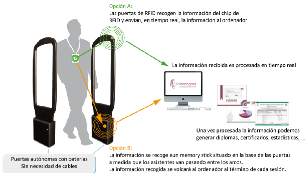
Figura 5. Principio de funcionamiento de un sistema RFID
