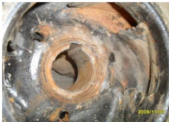
Figura 13. Cavitación y erosión en el impulsor
