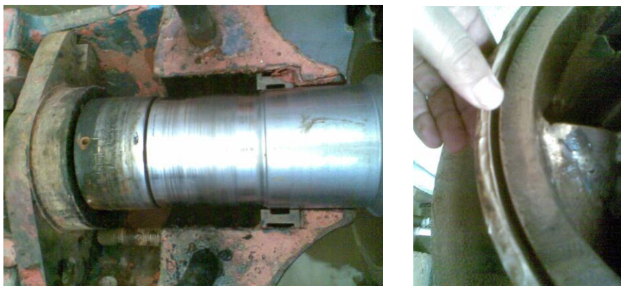
Figura 17. Deterioro de una de las camisas de sello y anillos de desgaste
