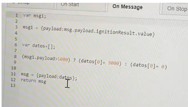
Función en Node-RED que verifica el umbral
