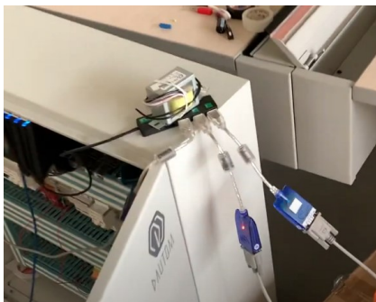
Conexión de dSPACEs al concentrador USB
