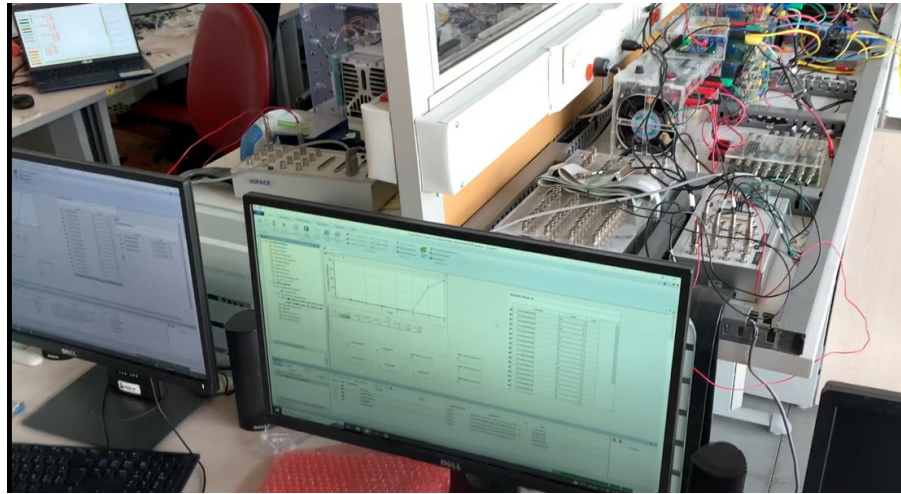
Escenario de experimentación, computadores mostrando ControDesk y módulos de conexión de las dSPACE.
