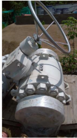
Figura 11. Válvula de bola del CPF Floreña
