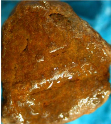
Figura 47. Microfotografía del segundo agregado tipo toba bajo el estéreo microscopio. Se destaca el grado de severo de alteración de la muestra.
