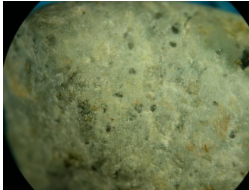
Figura 12. Microfotografía del segundo agregado tipo basalto bajo el estéreo microscopio. Se destaca la matriz con textura holohialina de tonalidad verde y los fenocristales hornblenda de color oscuro.
