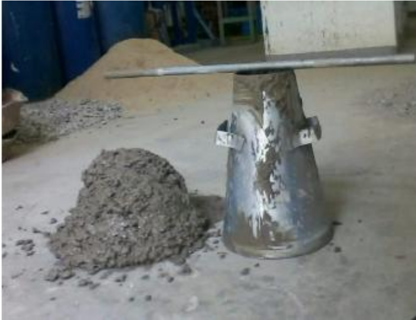
Imagen 8. Asentamiento en cono (P2): time 1 min (S = 138 mm).
