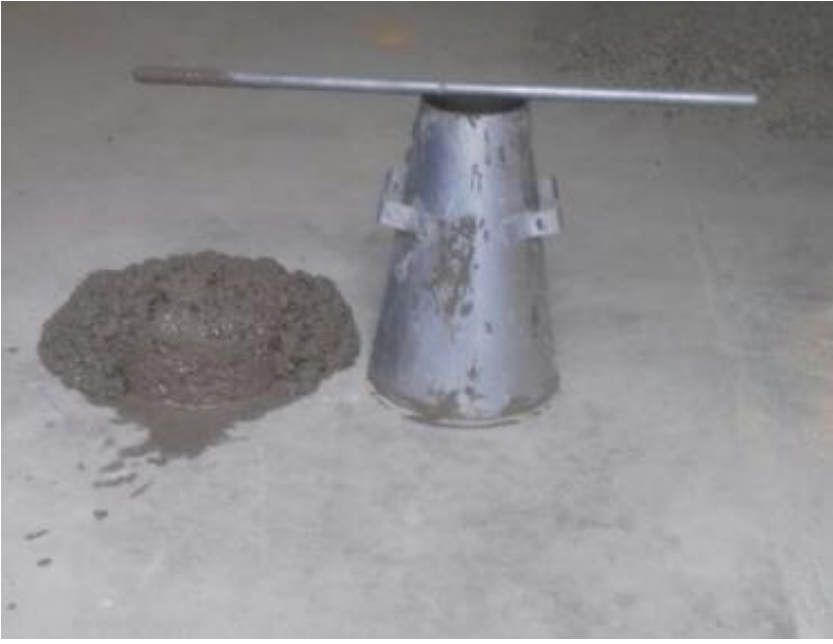
Imagen 15. Asentamiento en cono (P9): time 1 min (S = 165 mm).
