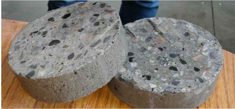
Imagen 17. Especímenes de concreto endurecido para ensayo de ion cloruro.
