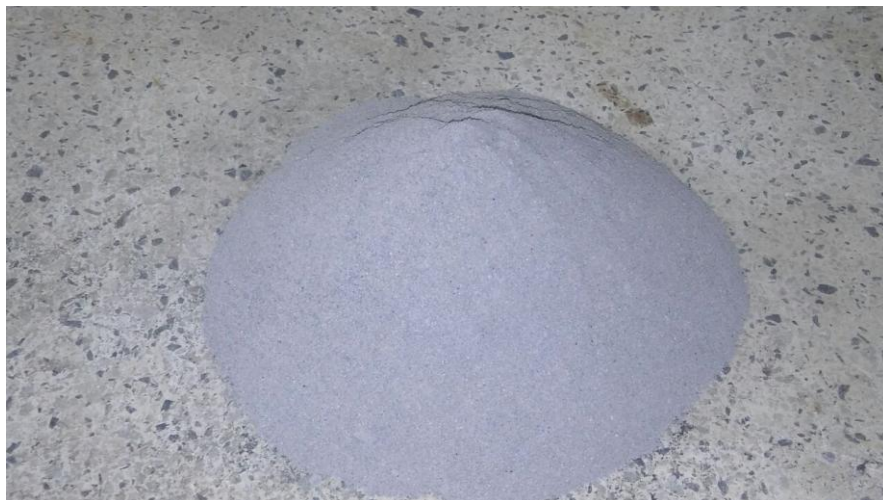
Imagen 4. Escoria de alto horno molida y tamizada.
