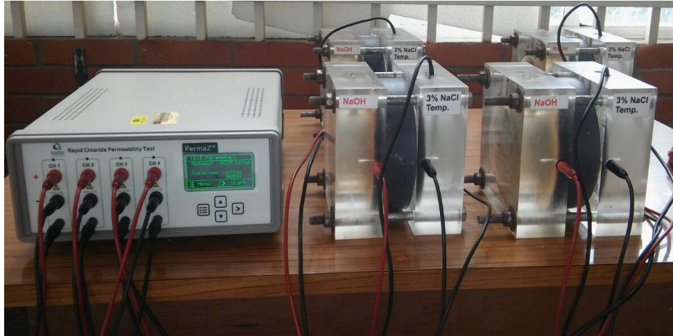
Imagen 19. Montaje final para ensayo de ion cloruro.
