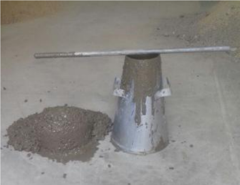
Imagen 9. Asentamiento en cono (P3): time 1 min (S = 155 mm).
