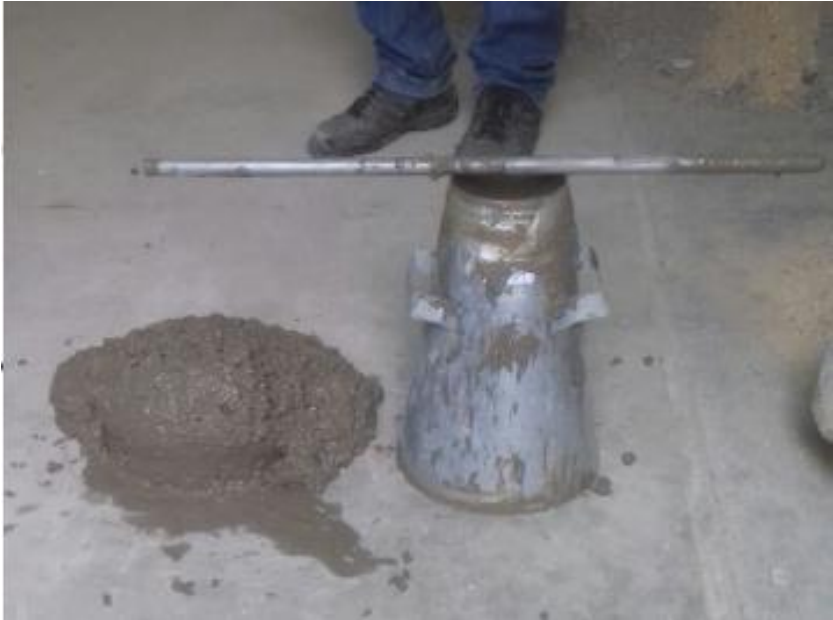
Imagen 10. Asentamiento en cono (P4): time 1 min (S = 158 mm).
