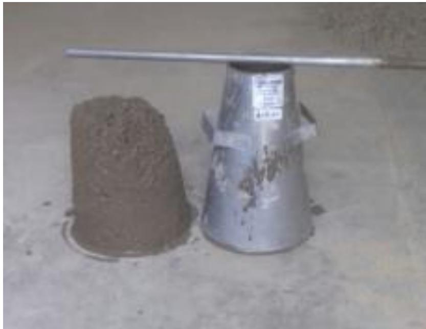
Imagen 13. Asentamiento en cono (P7): time 1 min ( S = 80 \text{ mm} ).
