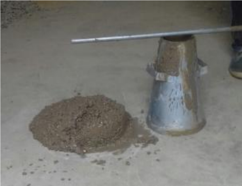
Imagen 7. Asentamiento en cono (P1): time 1 min (S = 168 mm).
