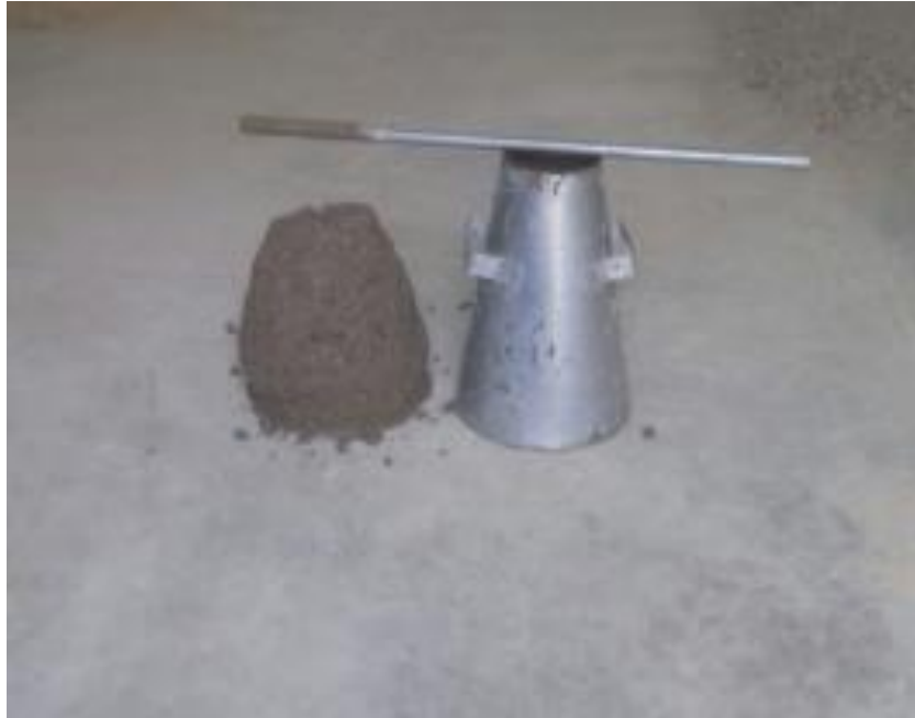
Imagen 12. Asentamiento en cono (P6): time 1 min ( S = 83 \text{ mm} ).
