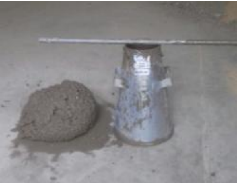
Imagen 11. Asentamiento en cono (P5): time 1 min (S = 145 mm).
