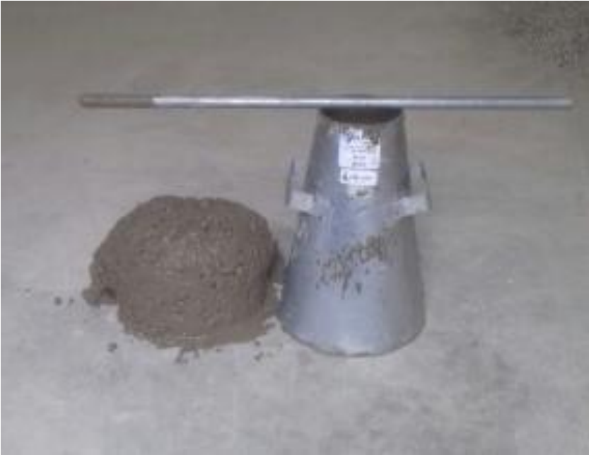
Imagen 14. Asentamiento en cono (P8): time 1 min (S = 157mm).
