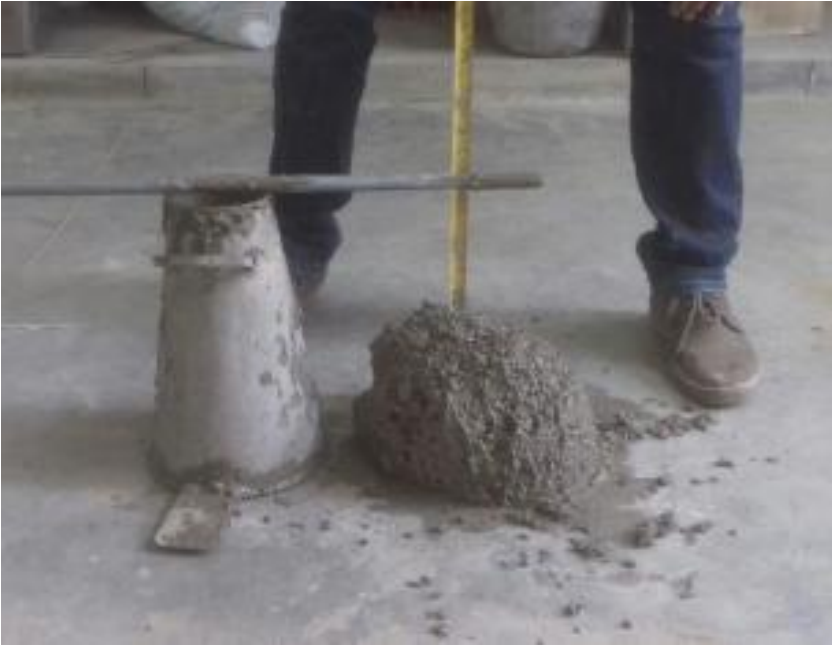
Imagen 6. Asentamiento en cono (P0): time 1 min (S = 85 mm).
