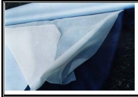
Una segunda tela, lienzo se usa para unir una espumilla muy delgada (5mm de espesor) y la tela Microtherm, este lienzo es muy delgado y permite también el flujo de aire, debe realizarse el ensamble de los tres materiales (tela Microtherm, espuma delgada y lienzo) para dar mayor resistencia al tapizado y poder realzar las formas dadas al cojín de espuma.
