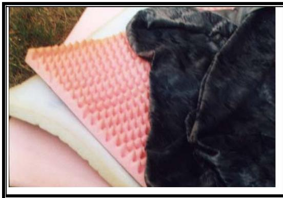
Para los almohadones del asiento y espaldar se selecciona cuatro tipos diferentes de espumas de poliuretano (ver propiedades generales del poliuretano en anexo E) que obedecen al diseño específico de dichos almohadones estos cuatro tipos de espuma (ver foto 5) cumplen con la norma ICONTEC 2019 y sus propiedades se describen a continuación:
