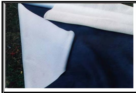
Se escoge para el recubrimiento de las superficies laterales e inferiores de cada almohadón y para los canales de sistema de sujeción de los almohadones a la estructura. El hule Ambla Tropicana, fabricado en Colombia por la empresa Plástiquimicas, es retardante al fuego, cumple con la normativa BS5790 Parte 1 tipo 2 grado ISO 7617-1 (1988), con frecuencia de frote  $\frac{1}{4}$  de ciclo por segundo. Muy fácil de limpiar resiste a los ácidos suaves alcalinos. Se puede limpiar con una gamuza
