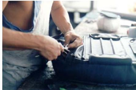
Los forros de los cojines del espaldar y el asiento cuentan con cierres que permiten el cambio de las espumas por envejecimiento de las mismas.
