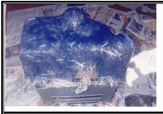
Para la elaboración de las carcasas del Motor y del Joystick se escoge la resina poliester, reforzada con fibra de vidrio, gracias a que es un material que permite hacer piezas por moldeo de forma sencilla, y a que permite elaborar cualquier tipo de pieza, para la elaboración de los modelos de las carcasas se uso el barro de moldeo amarillo.
