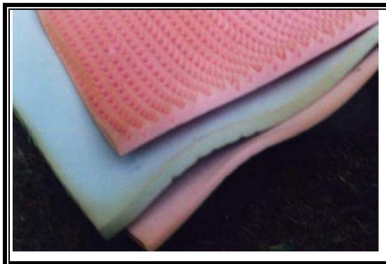
La espuma rosada de alta densidad es la capa inferior, porque estará en contacto con el sistema de resortes se requiere de mayor resistencia, ya que esta sometida a fuerzas de desgarramiento.
