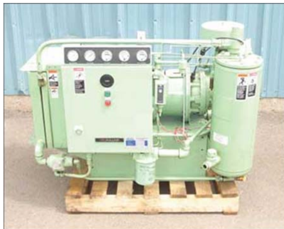
Figura 15 Compresor Sullair 10B30
