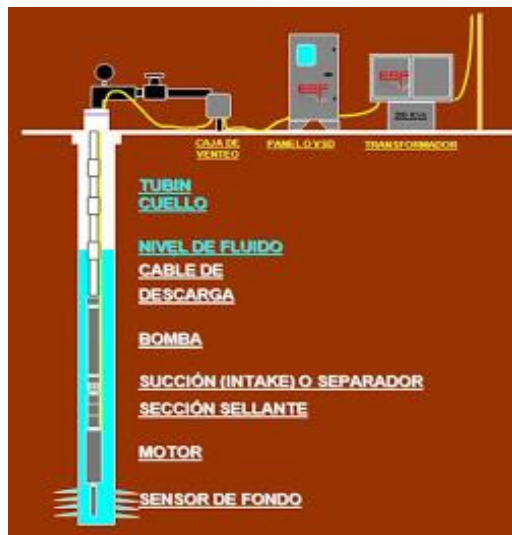
Figura 2. Equipos de superficie para un pozo productor de crudo con bombeo electro-sumergible.
