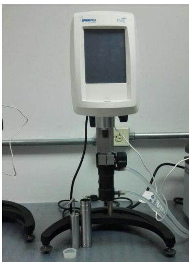
*Figura 41.* Viscosímetro Brookfield con adaptador UL
