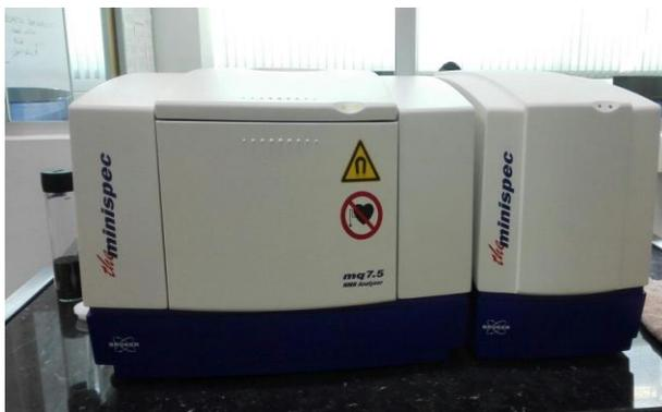
Figura B.8. Equipo baja resolución Minispec mq 7,5 Bruker.
