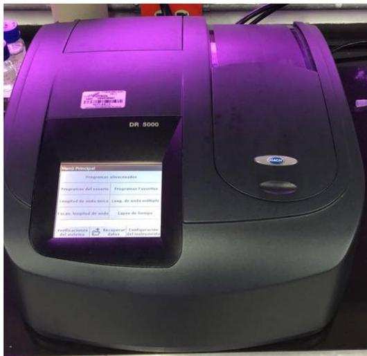
Figura C.4. Espectrofotómetro marca HACH para determinación de absorbancia.
