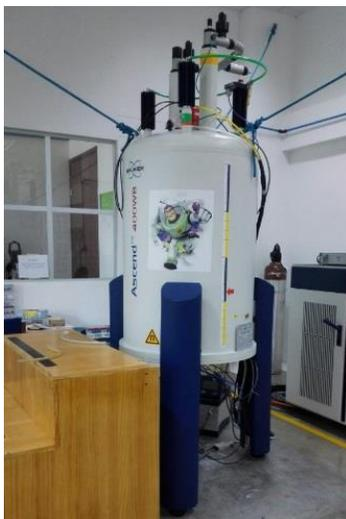
Figura 42. Espectrómetro de alto campo BRUKER AVANCE III de 400 MHz usado para análisis DOSY
