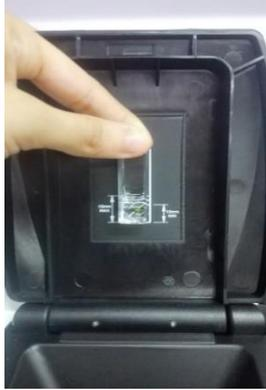
Figura C.2. Altura de volumen en celda para medición de tamaño
