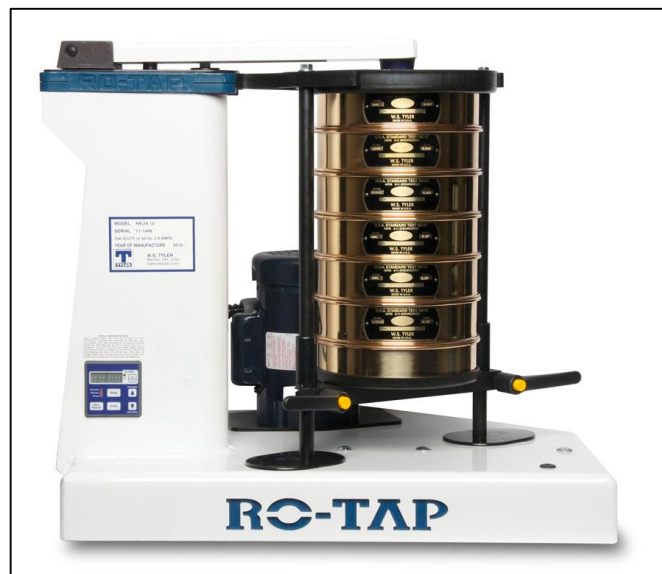
Figura 25. Modelo del conjunto de tamices y zaranda mecánica.
