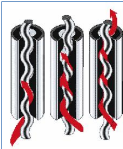
Figura 8. Desplazamiento Del fluido En Sistema PCP
