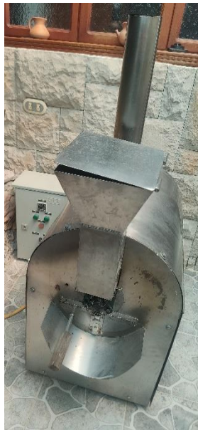
Figura 54. Prototipo maquina tostadora de café construido.
