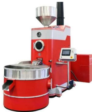
Figura 6. Tostadora de Lecho Fluido.
