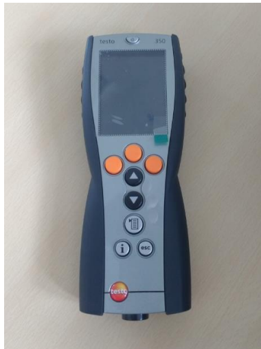
Figura 15 Unidad de Control TESTO 350
