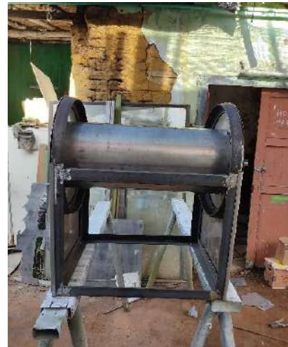
Figura M.11. Instalación de la cámara de tostado en la estructura.
