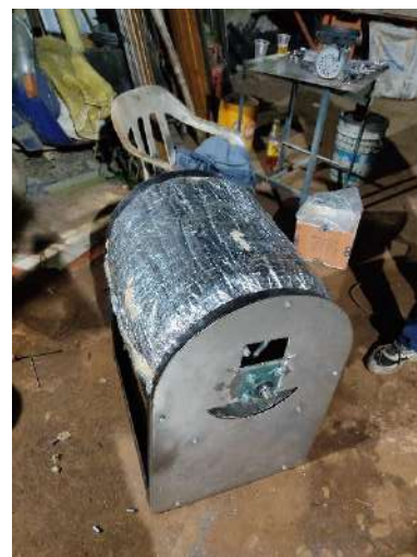
Figura M.16. Ensamble completo de la estructura con el recubrimiento de lana de vidrio.
