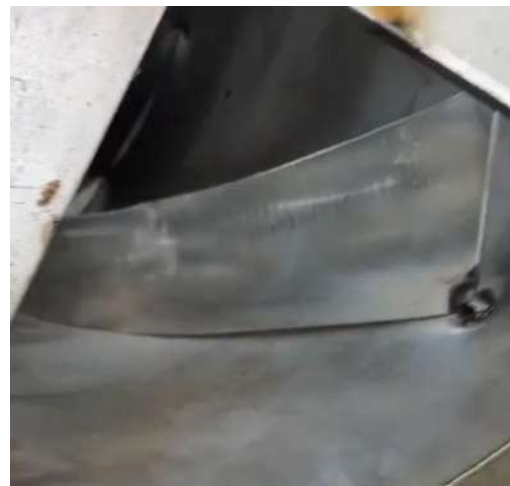
Figura M.9. Soldadura de las aspas en el interior de la cámara de tostado.
