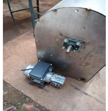
Figura M.23. Instalación del Motorreductor en la base soldada.
