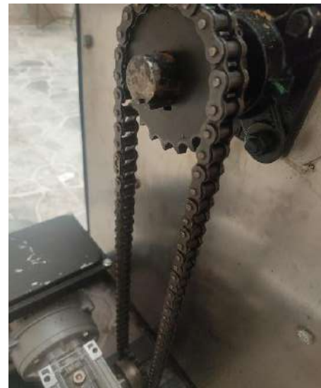
Figura M.25. Instalación de cadena en cada uno de los piñones.
