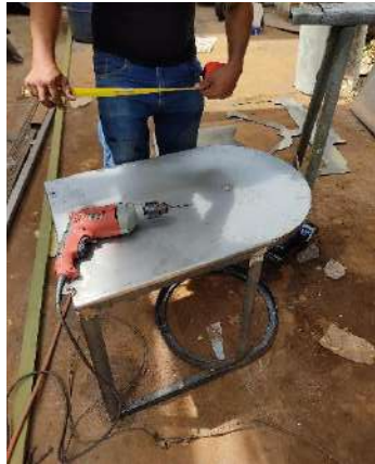
Figura M.6. Posicionamiento lamina posterior en la estructura.
