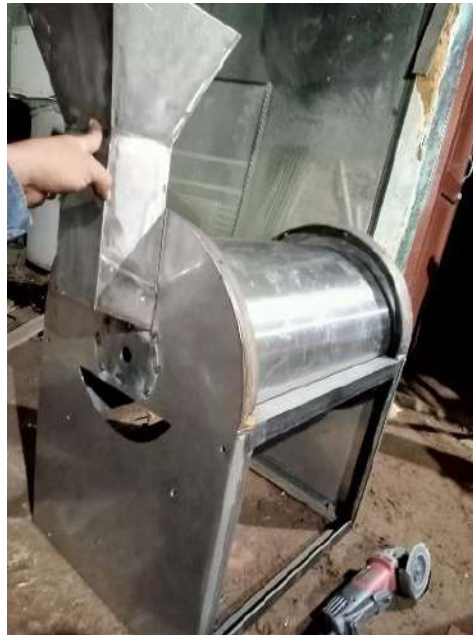
Figura M.17. Ensamblaje de Tolva de alimentación a la estructura.
